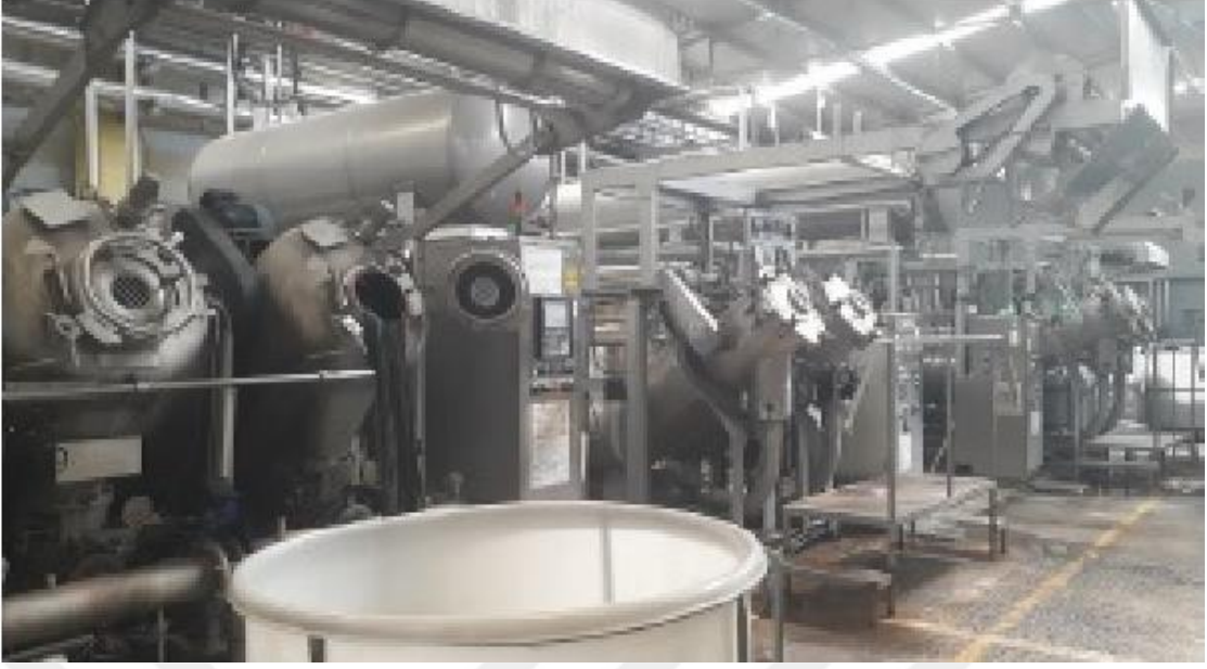
Şekil 3.2. T1 için Exhaust (çektirme) boyama uygulanması
