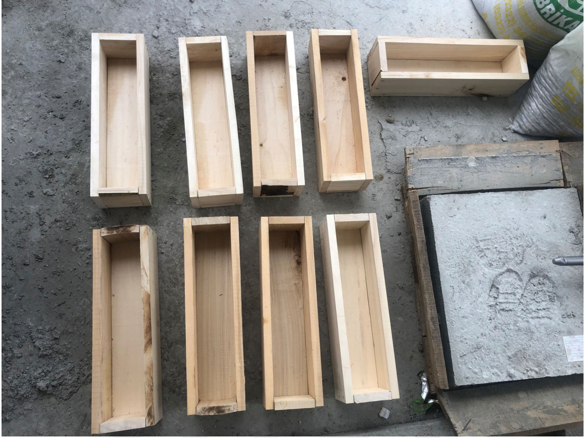
Şekil 3.2. Ahşap kalıpların kalıp yağı ile yağlanması.
