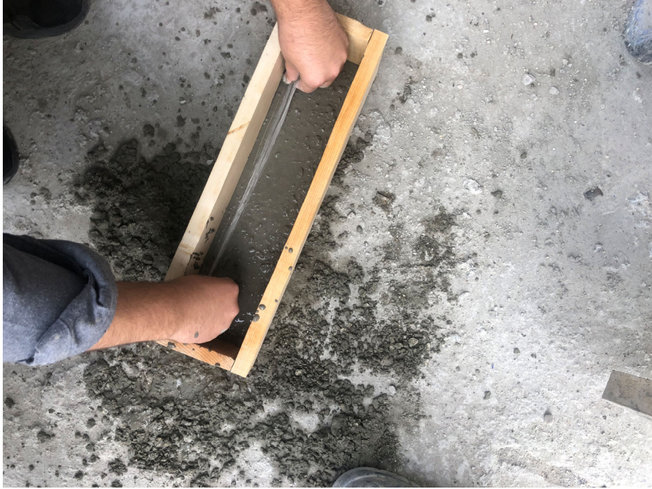
Şekil 3.4. Beton numunesi içerisine optik fiber yerleştirilmesi.
