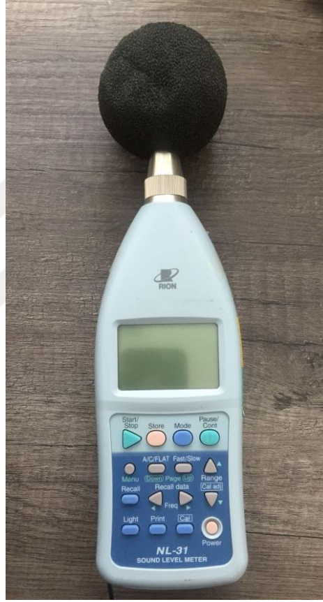
Şekil 3.1 Gürültü ölçümünde kullanılan cihaz
