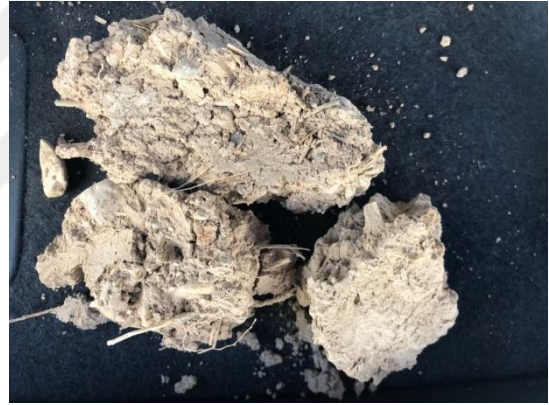
Şekil 3.4: Kerpiç moloz taş karışımı örneği (Aytemiz,2020)
