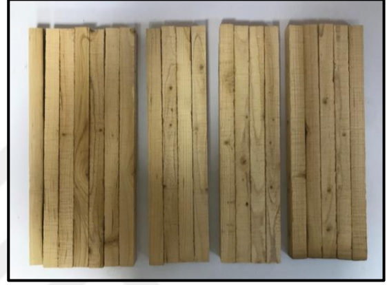
Şekil 3.37: Eğilme deneyi numuneleri (Aytemiz,2021)
