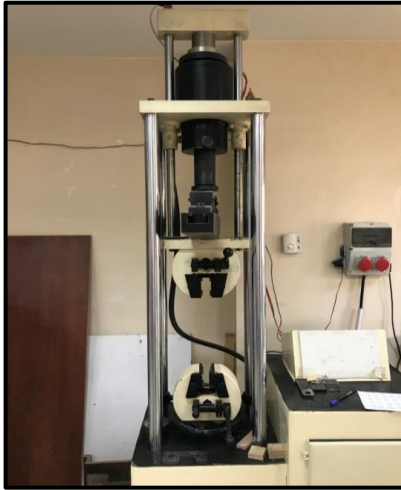
Şekil 3.42: Üniversal test cihazı (Aytemiz, 2021)
