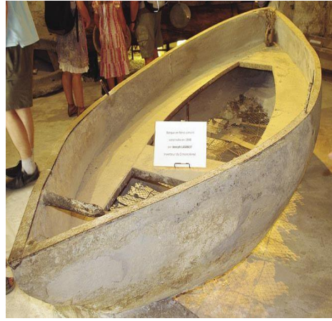
Şekil 2.4.A , Şekil 2.4.B Louis Joseph Lambot’un teknesinin orijinal ve hasarlı görüntüsü(Url-3)
