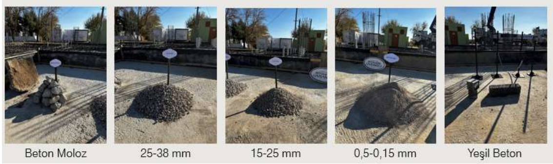
Şekil 4.13. Molozlardan Yeşil Betona Geçiş Süreci Sazgın Köyü 2024 (Kaynak: Yazar)
