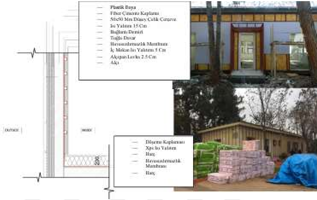
Şekil 2.118. Binanın Dış-Temel ve Duvarlarına Yalıtım Detayları [Url-40]
