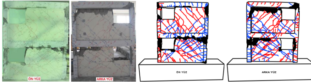
Şekil 11. Deney sonrası, Deney Numunesi 4 (ISWSSW)'nin görünümü Figure 11. View of Specimen 4 (ISWSSW) at the end of the test
