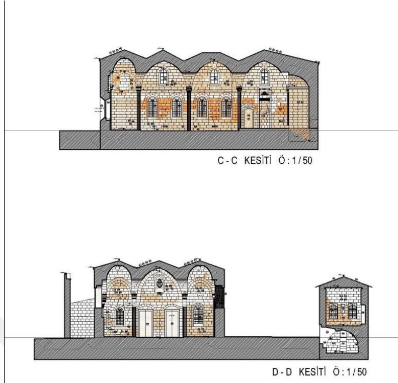
Şekil 8. 41. Ömer Ersoy Kültür Merkezi C-C Kesiti ve D-D Kesiti Restorasyon Sonrası (Gaziantep Kudeb Arşivi, 2019)
