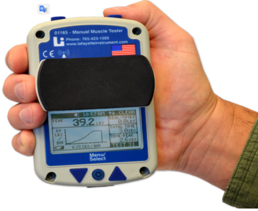
Şekil 4.3. Lafayette el tipi dinamometre
