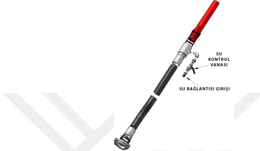
Şekil 4. 14. Nozulu oluşturan parçalar aktarım hortum bağlantısı ile (Özcan,2021)
