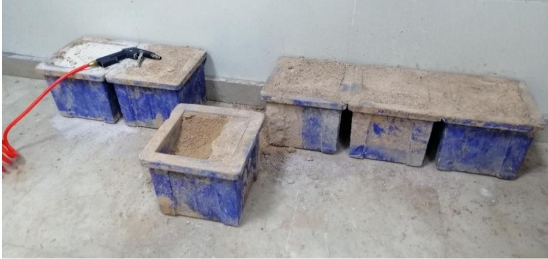
Şekil 5. 17. Operatör 2 tarafından üretilen hasarlı numunelerin kalıptan çıkartılması (Özcan, 2020)
