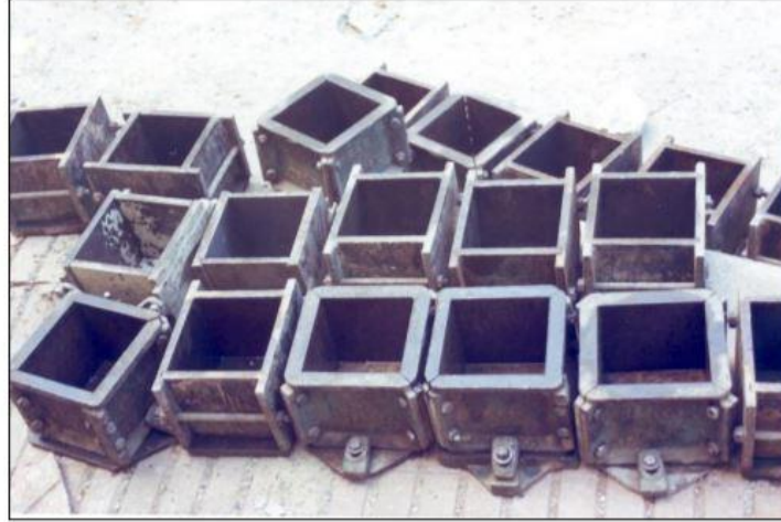
Şekil 4. 17. Çalışma sırasında kullanılan çelik kalıplar (Işık, 2002)
