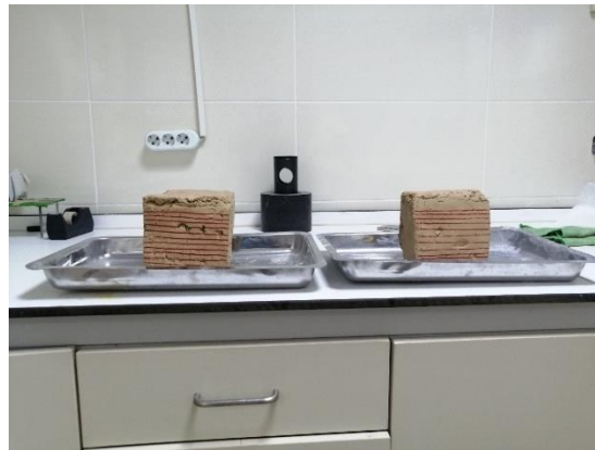
Şekil 5. 23. Su emme deneyi için hazırlanan numuneler (Özcan, 2021)
