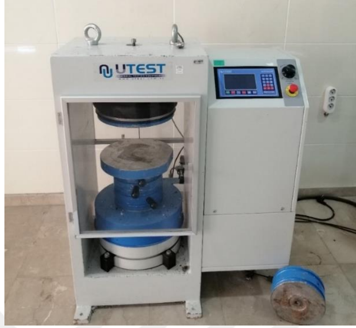
Şekil 5. 19. UTest otomatik deney presi (Özcan, 2020)
