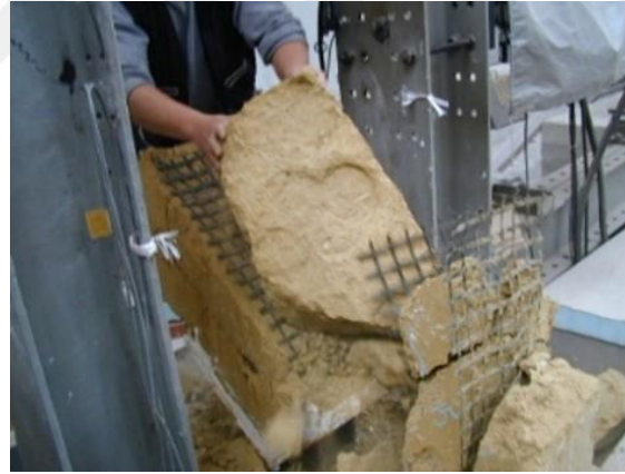
Şekil 2. 20. Tel örgü Hatıllı kerpiç duvar yöntemi, (Işık.2009)
