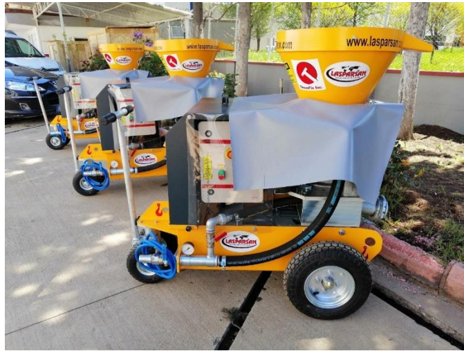
Şekil 4. 2. Yeni nesil kuru sistem beton püskürtme makinesi (Özcan,2019).
