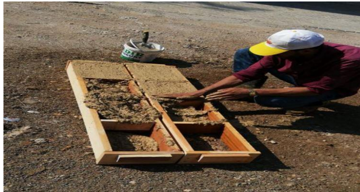
Şekil 2. 15. Dinlendirilmiş kerpiç harcı son halini almak için kalıplarda şekillendiriyor, (Özcan,2019)
