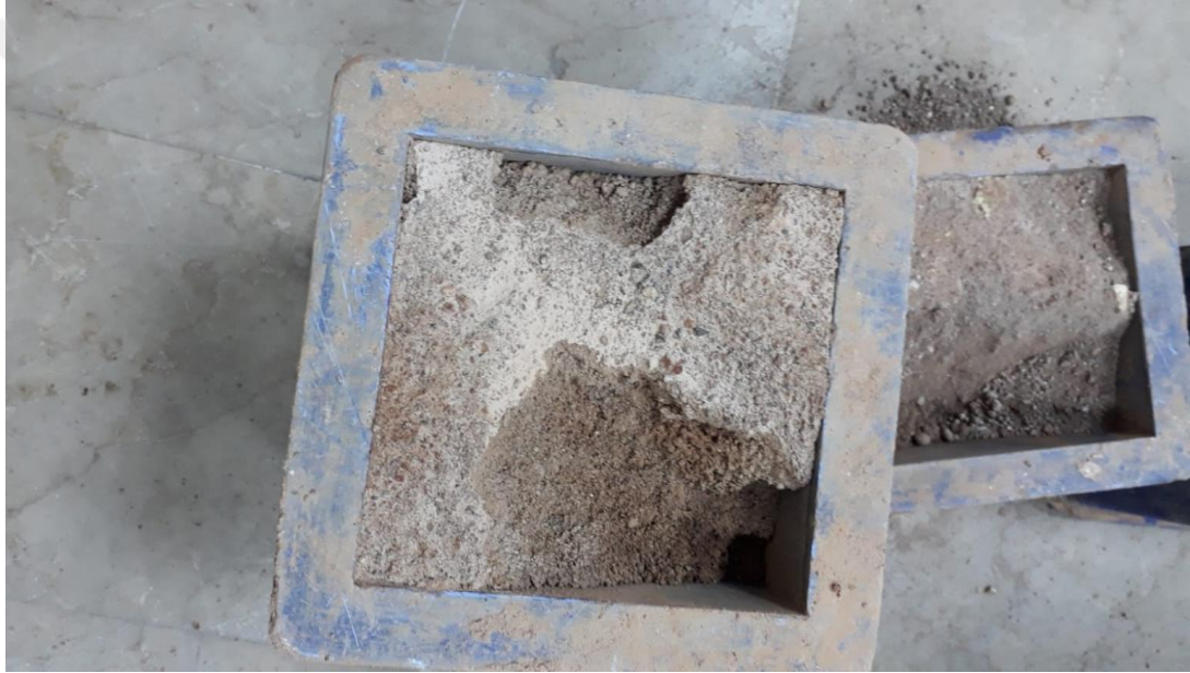
Şekil 5. 18. Operatör 2 tarafından üretilen hasarlı numuneler (Özcan, 2020)
