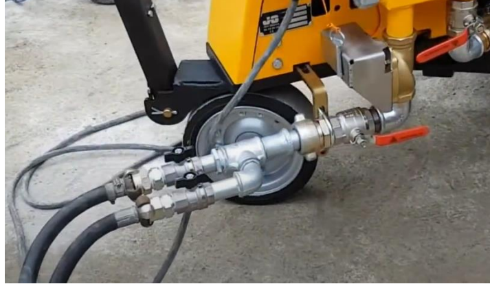
Şekil 4. 11. Kuru sistem püskürtme beton makinesi ve kompresör makinesi bağlantısı (Özcan,2021)
