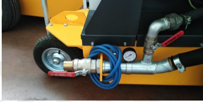
Şekil 4. 10. Kuru sistem püskürtme beton makinesinin basınçlı hava girişi (Özcan,2021)
