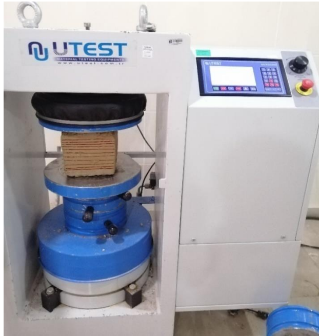
Şekil 5. 25. Nemli numunenin basınç dayanım testi (Özcan, 2021)
