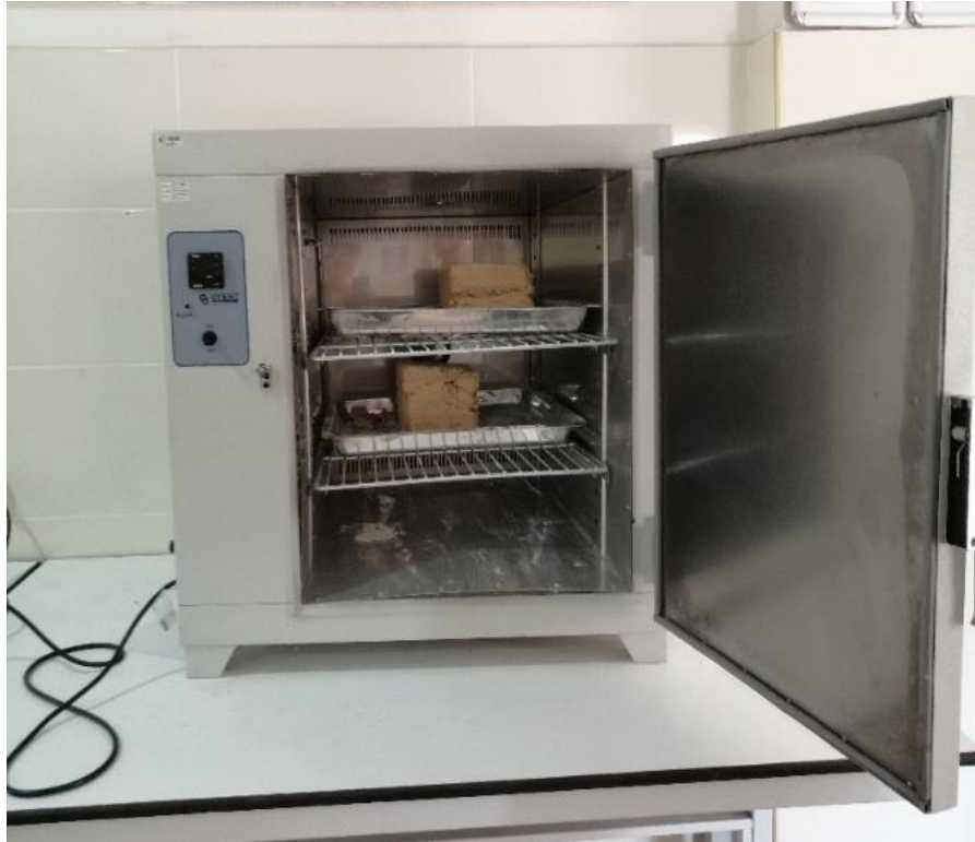
Şekil 5. 20. Etüv makinesinde ki numuneler (Özcan, 2019)
