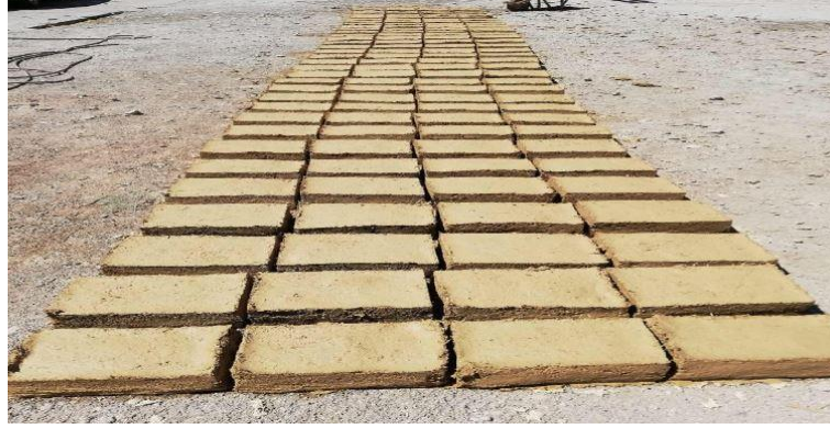
Şekil 2. 16. Kalıp da şekil alan kerpiç bloklar kurutulma işleminde, (Özcan,2019)
