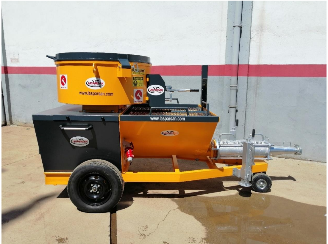
Şekil 4. 3. Yeni nesil yaş sistem beton püskürtme makinesi (Özcan,2020)
