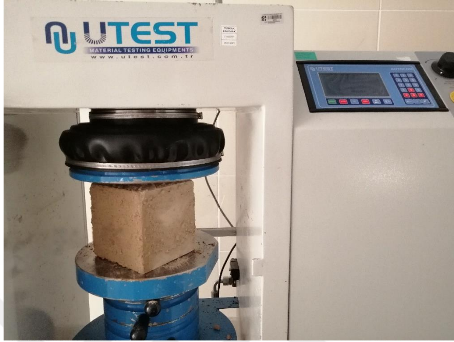
Şekil 5. 21. Basınç dayanım testindeki numune (Özcan, 2021)
