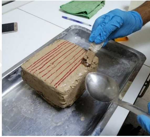
Şekil 5. 22. Numunelere eritilmiş parafin sürülmesi (Özcan, 2021)
