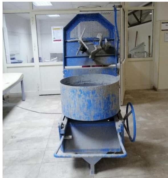
Şekil 4. 13. Yatay harç karma makinesi (Özcan,2021)
