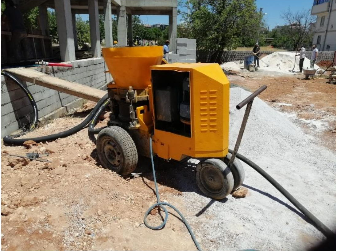
Şekil 5. 1. Makine üretimi K260 model püskürtme beton makinesi (Özcan, 2020)
