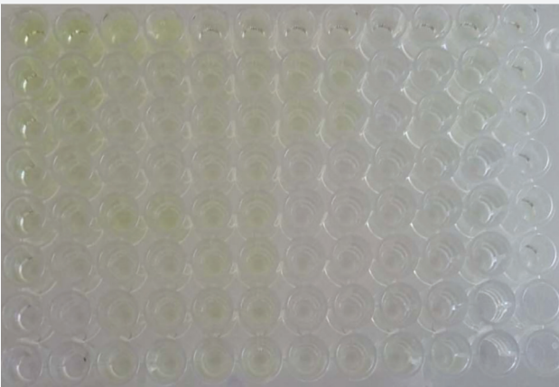
Şekil 2. Farklı konsantrasyonlarda \alpha -amilaz kullanımının neden olduğu renk değişikliklerini gösteren CNPG3 yöntemi. CNPG3 testinde, CNPG3 ilavesiyle açık sarı bir renk oluşur ve \alpha -amilaz aktivitesi spektrofotometrede (405 nm) okunarak belirlenir
