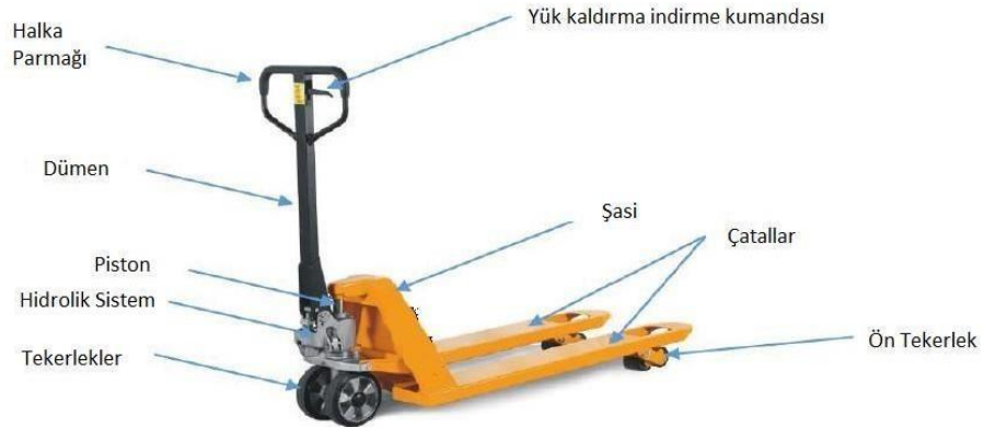
Şekil 5.4. Transpalet Elemanlar
