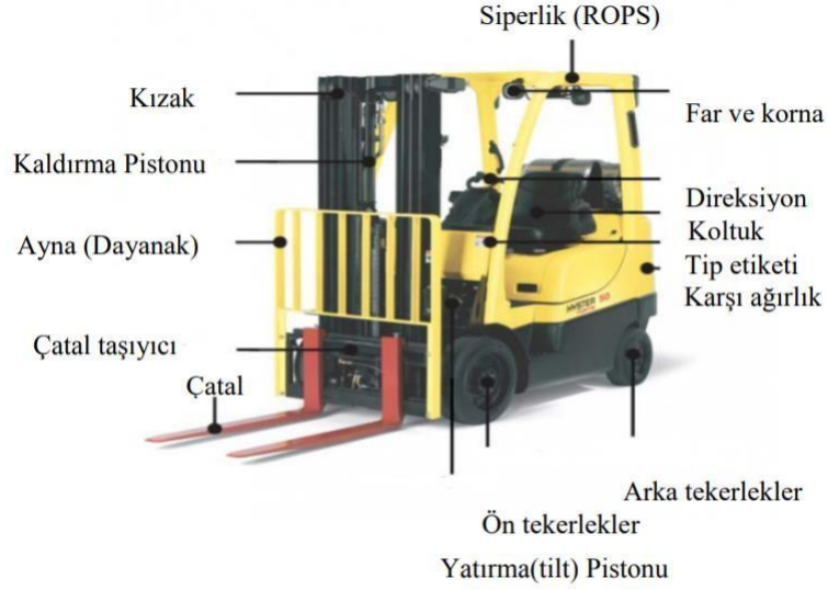
Şekil 5.6. Forklift Elemanları
