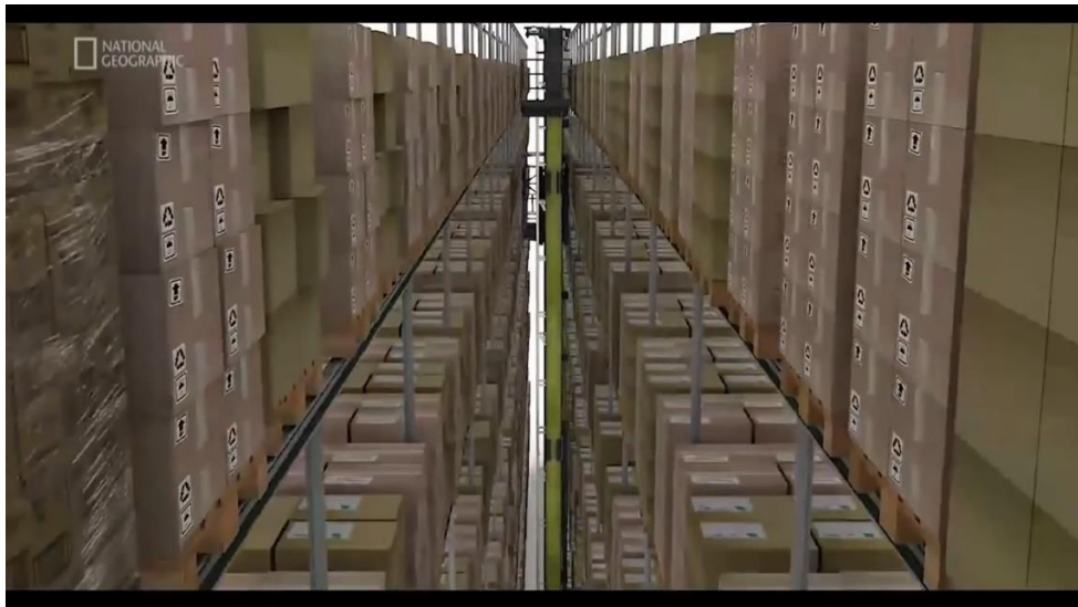
Şekil 5.16. Otomatik Depolama ve Boşaltma Sistemiyle Çalışan Depolardaki Kule
