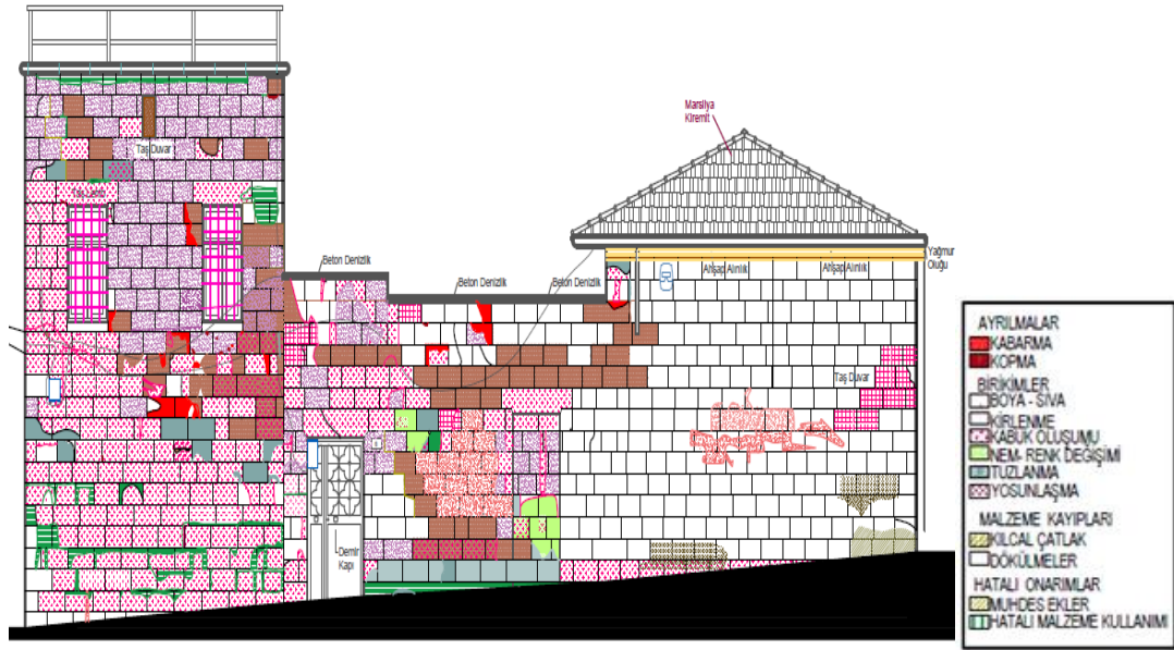
Şekil 4.41. 683 Ada 6. Parsel kuzeybatı cephesi malzeme bozulma haritası
