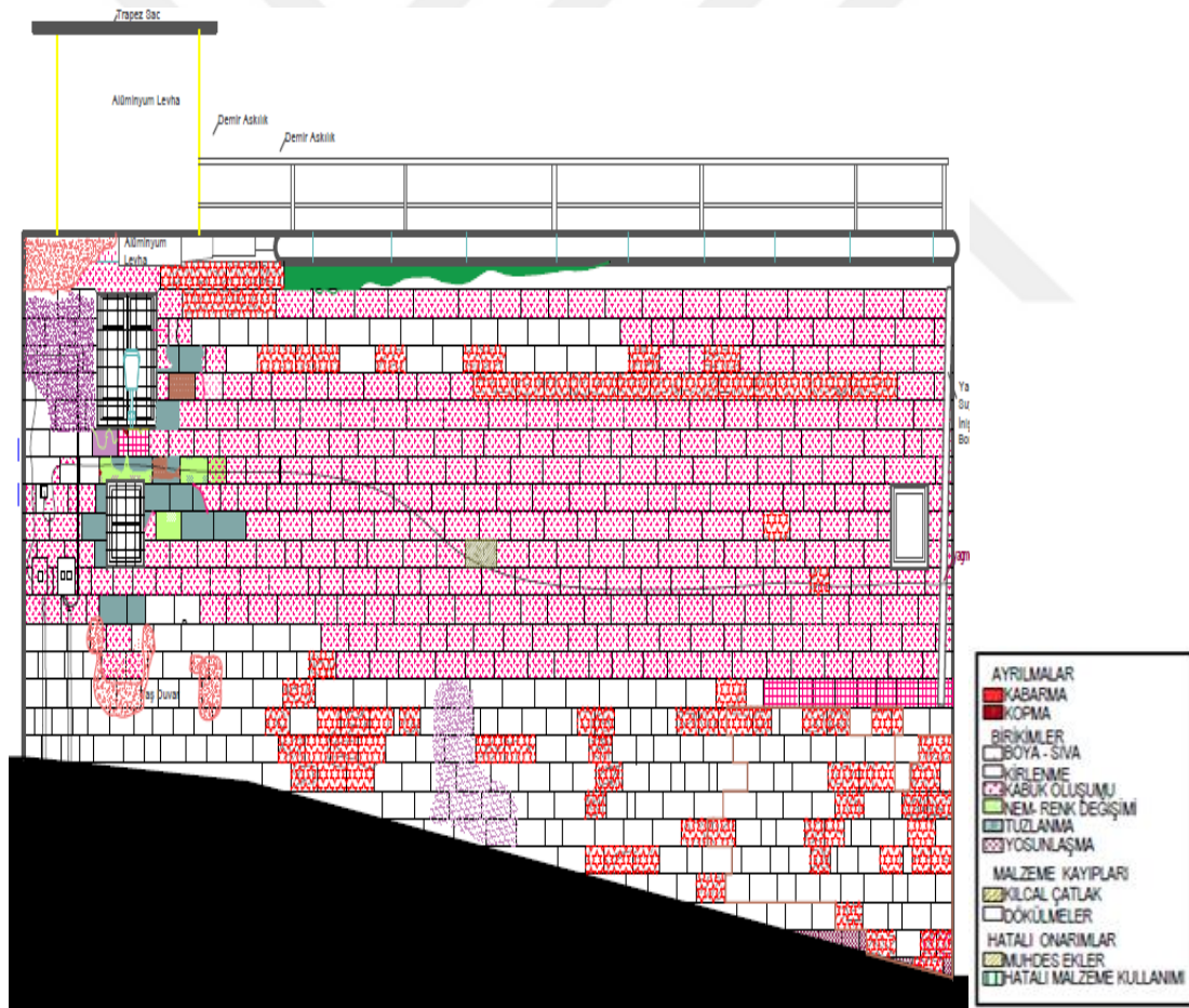
Şekil 4.41. 683 Ada 6. Parsel kuzeybatı cephesi malzeme bozulma haritası
