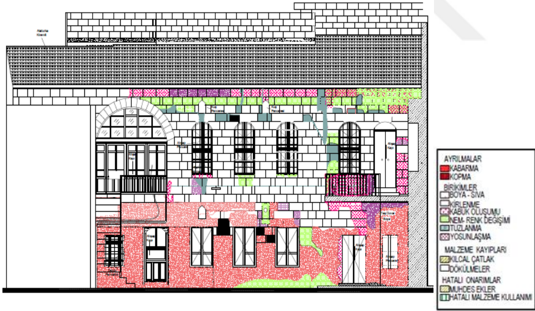
Şekil 4.40. 683 Ada 5. Parsel yapı cephesi malzeme bozulma haritası
