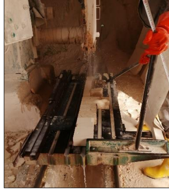
Şekil 4.3. Alınan örneklerden 70X70X70 mm küpler şeklinde hazırlanması (Demirkol, B., 2019)
