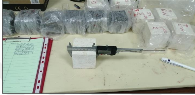
Şekil 4.4. Numunelerin boyutlarının Dijital kumpas ile ölçülmesi (Demirkol, B., 2019)
