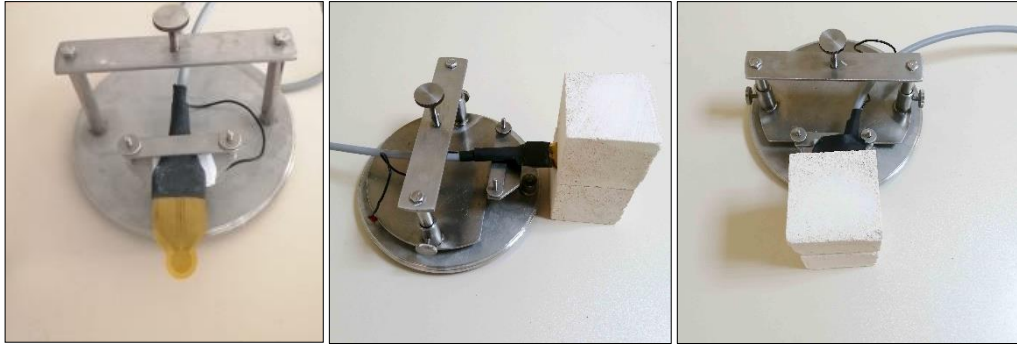
Şekil 4.10. Numunelerde Isı iletimi ölçümü (Demirkol, B., 2020)
