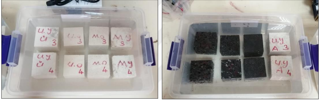
Şekil 4.11. Sodyum sülfat dekahidrat çözeltisinde bekletilen numuneler (Demirkol, B., 2020)
