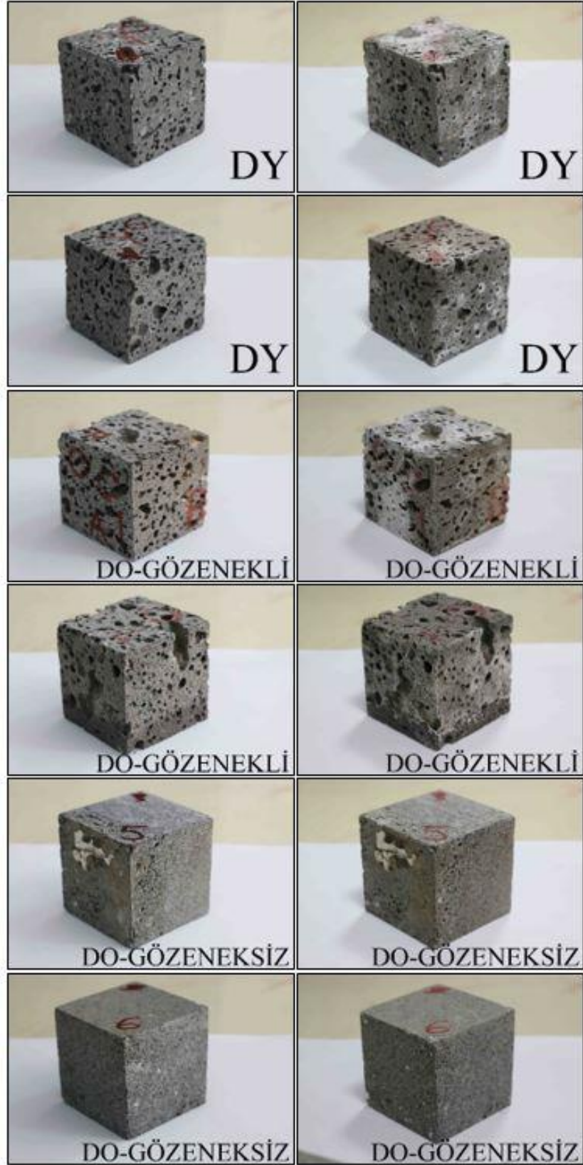
Şekil 4.14. Diyarbakır bazalt taşı numunelerinin başlangıçtaki ve eskitme süreci sonundaki görünüşleri (Demirkol, B., 2020)
