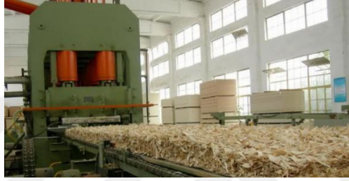
Şekil 2.28: Yönlendirilmiş yonga levha (OSB) üretimi (URL-23)
