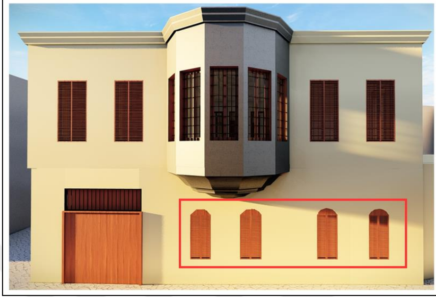
Şekil 3.19 Restorasyon sonrası sokak cephesi pencere boşlukları (Emine Gögüş Mutfak Müzesi, 2022, Kaynak: Yazar)
