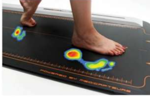
Şekil 3.2. Win Track Basınca Duyarlı Yürüme Analizi Cihazı (58)
